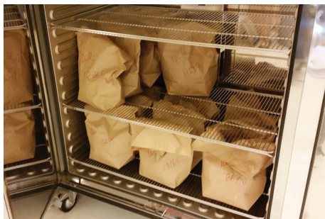
TØRKE OG VEIE PRØVE FOR Å FINNE FUKTIGHET
