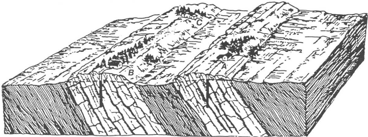
Figur 4.13. Forurensning av grunnvannsmagasin med lagdelte oppsprukne bergarter
