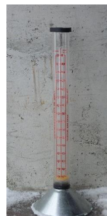
Bilde 2. Flowmeter. Foto: John Ingar Øverland
