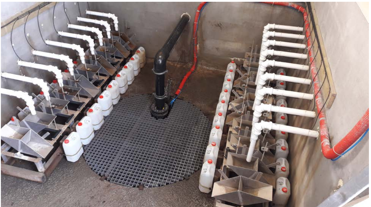
Målinger av avrenning fra drensgrøfter og overflatevann fra 9 ruter.
