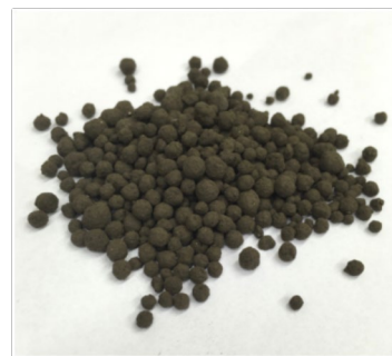
Ferdig produktet kalles «Nutrient enriched biochar» (NEB). Granulatene vil inneholde en balansert mengde av makro og mikro plantenæringsstoffer. Produktet er sterilisert, lagringsstabil og tilpasset for spredning på jorda med eksisterende traktorutstyr
