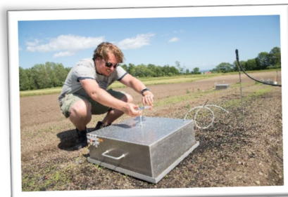
NIBIO stipendiat og ingeniør Simon Weldon måler drivhusgasser fra jorda ved forsøksfeltet sommeren 2018
