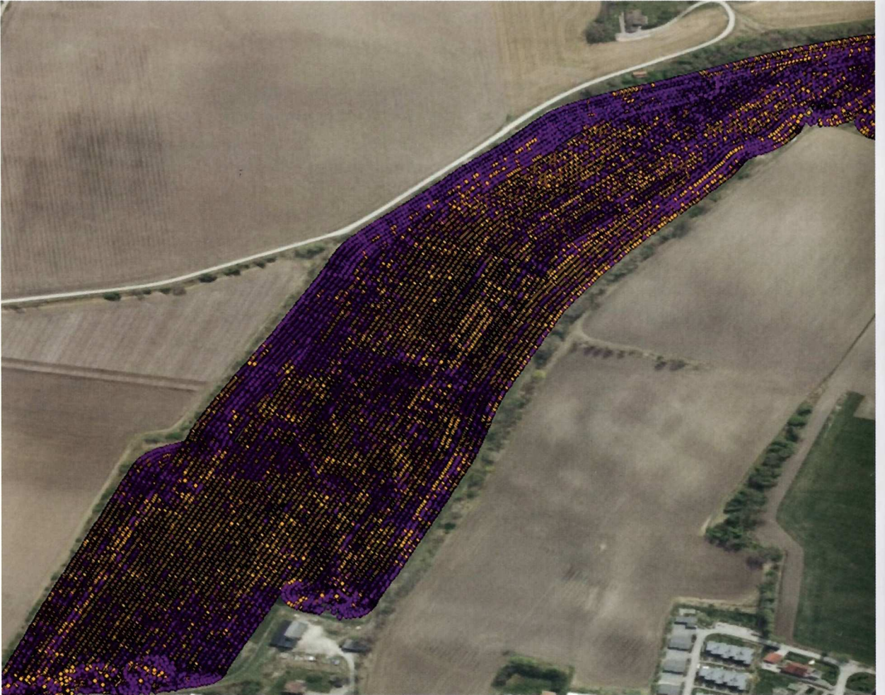
Figur 2. Sprøytekart i felt 4 basert på kamera-basert sprøytekriterium («relativ ugrasdekning, toftøblada ugras») hvor lilla og oransje prikker representerer bilder med ugrasmenngde hhv. over (sprøytet) og under (usprøytet) terskelverdien 0,035. Illustrasjon: Therese W Berge/NIBIO.
